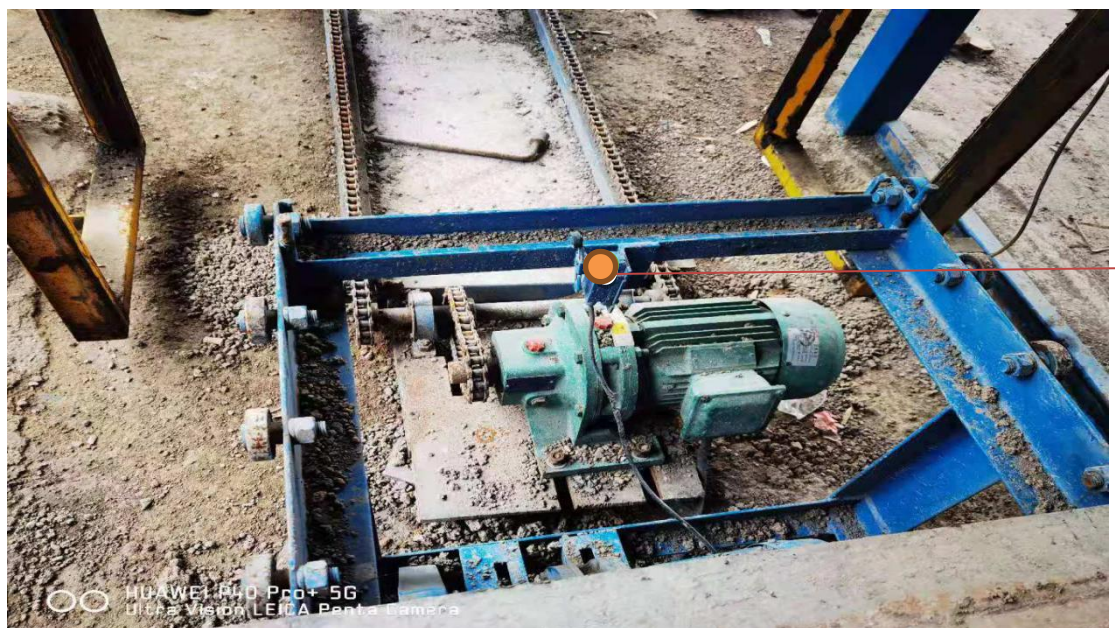
5. QTJ4-25A 型砌块成型自动感应器位置图
